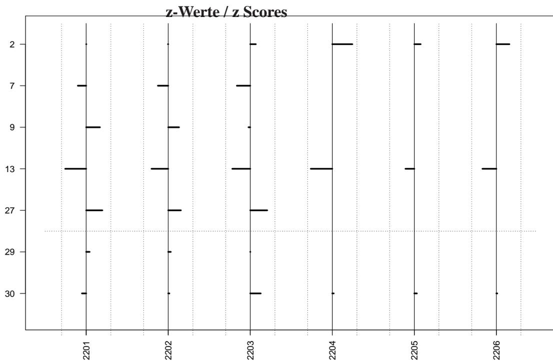
Senkrecht finden sich die Labore, waagrecht jeweils die Proben. Die Balken für die verschiedenen Proben liegen auf einer Ebene nebeneinander. Rote Balken markieren Labore, deren Labormittelwert für diese Probe einen z-Wert kleiner -2 oder größer 2 aufweist.
