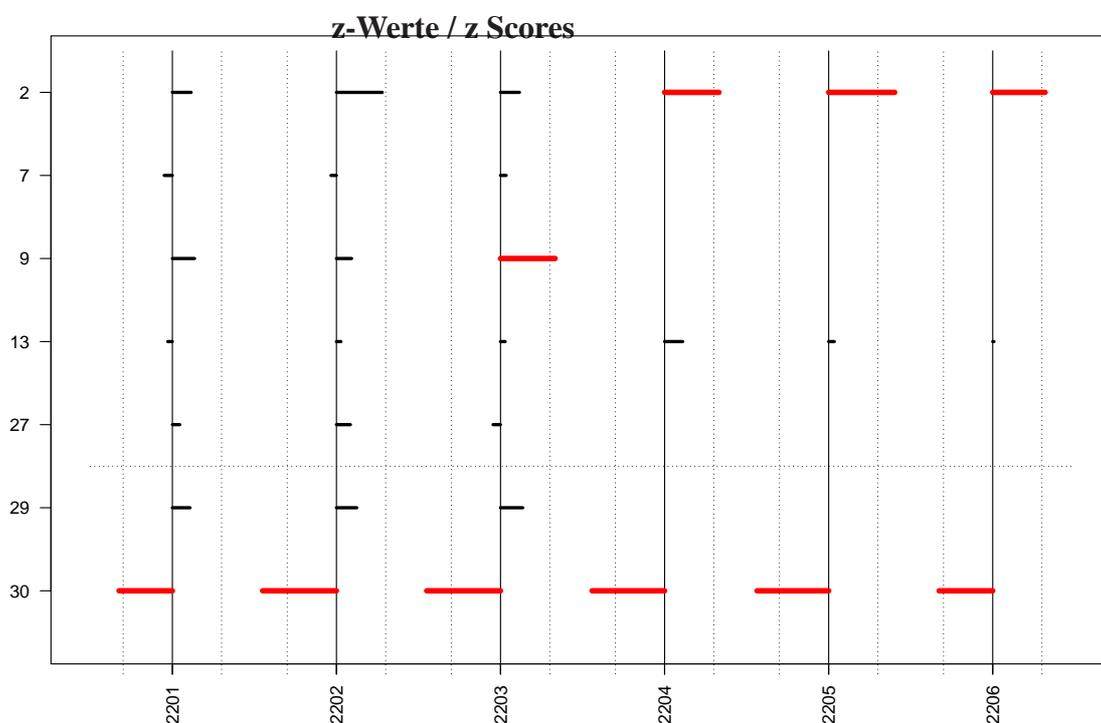
Senkrecht finden sich die Labore, waagrecht jeweils die Proben. Die Balken für die verschiedenen Proben liegen auf einer Ebene nebeneinander. Rote Balken markieren Labore, deren Labormittelwert für diese Probe einen z-Wert kleiner -2 oder größer 2 aufweist.
